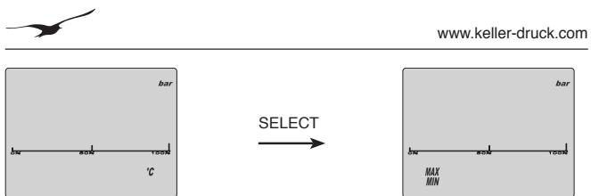
Wechselt zwischen der Temperatur-Anzeige und der Min./Max. Druck-Anzeige im unteren Teil des Displays.
